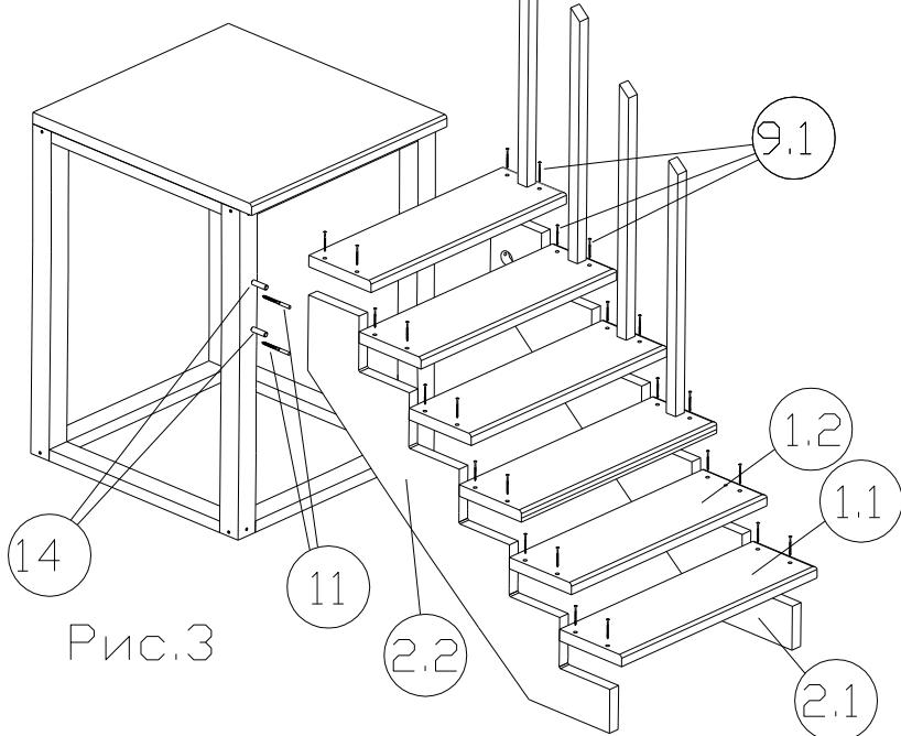
4. Присоединить к столбам (3.1), (3.4) косоуры (2.4), (2.3) при помощи шкантов (14) и сантехнических болтов (11), затянуть болты гайками. Установить все ступени с балюсинами (шаг 2) на косоурах и прикрепить их к косоурам саморезами L=70мм (9.1).
