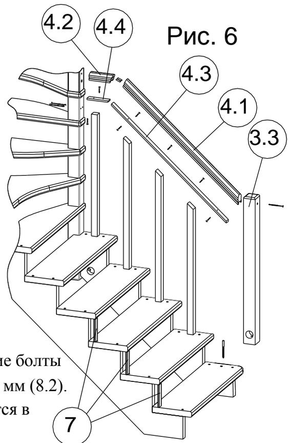
7. Закрыть отверстия под саморезы, сантехнические болты и шпильку, приклеив заглушки Ø12 мм (8.1) и Ø50 мм (8.2).
