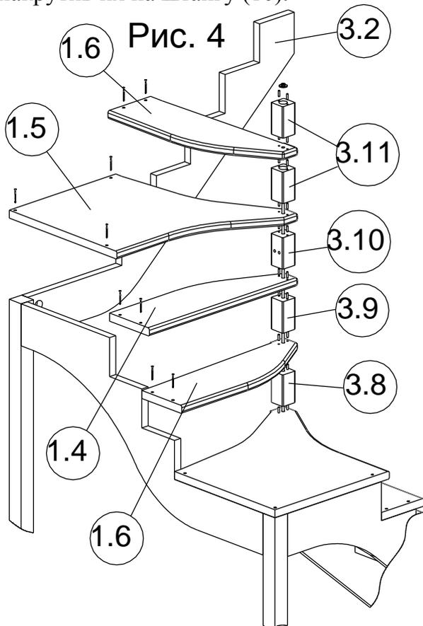
5. Присоединить ко вставкам (3.11)-косоур (2.5) при помощи шкантов 16x60 (14.1) и сантехнических болтов М10х100 (11.2). Установить ступень (1.7) с балясиной (шаг 2) и столб (3.4), используя шканты 8x30 (14.2). Ступень прикрутить к косоурам саморезами L=70мм (9.1). Притянуть столб гайкой М12 (12.2) с шайбой (13.2), накрутив их на штангу (10). Установить ступени (1.2) с балясинами (шаг 2), прикручивая их к косоурам саморезами L=70мм (9.1).
