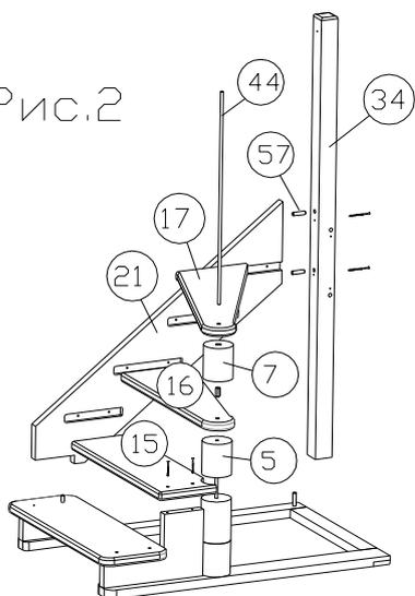
3. Присоединить тетиву 2 (38) к столбу 1 (34) при помощи шкантов L=60мм (57). Установить ступени (18, 19, 20, 32) и втулки (5)х3, (6) как в предыдущем шаге (очередность показана на рис. 3). Притянуть ступени первого пролета к тетиве 1 саморезами L=70мм (51). На штангу (44) надеть столб 2 (35) и притянуть гайкой. Притянуть столб 1 (34) к тетиве 2 (38) саморезами L=100мм.
