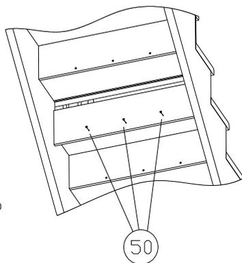
5. В ступень 1 (14) вкрутить сантехнический болт, на него установить столб заходной (13) и затянуть гайкой. Притянуть столб заходной к тетиве 1 (21) саморезами L=100мм. Прикрутить балясины (23) саморезами L=40мм (50) к планке облицовки (41). Планку облицовки с балясинами прикрутить к тетиве 1 (21) саморезами L=40мм (50). Прикрутить подпоручень к балясинам, а затем поручень (22) к подпоручню саморезами L=40мм (50). Поручень притянуть к столбам (13) и (34) саморезами L=100мм.
